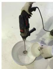
Mezclar los componentes **A + B** con un batidor a bajas revoluciones durante al menos 3 minutos, hasta obtener una perfecta homogeneización. (Nunca mezclar manualmente)
