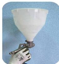
Aplicar **Mortecril line** con llana de acero inoxidable o con pistola de proyectar a espesor de 2-3mm en todos los puntos.
