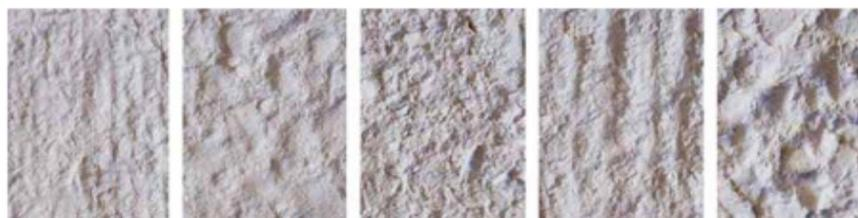
CSP - 6 Fresado medio      CSP - 7 Granallado profundo      CSP - 8 Fresado con picas ligero      CSP - 9 Fresado con picas medio o fresado profundo      CSP - 10 Fresado con picas profundo
