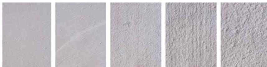
CSP - 1 Pulido ligero      CSP - 2 Pulido normal      CSP - 3 Granallado ligero o pulido profundo      CSP - 4 Fresado ligero      CSP - 5 Granallado medio
