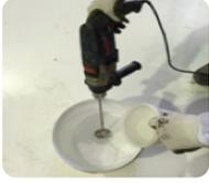
Mezclar los componentes **A + B** con un batidor a bajas revoluciones durante al menos 1 minuto, hasta obtener una perfecta homogeneización.
